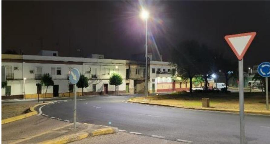
Nueva Iluminación en Rotonda bajo A49. Nueva columna 9m + luminaria vial AMPERA
